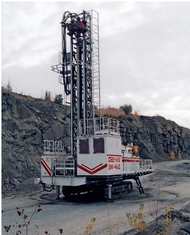
Первый отечественный буровой станок СБШ-160/200-40Д с дизельным приводом
