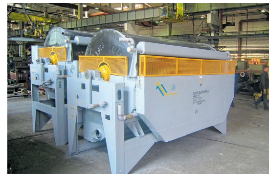
Двухбарабанный магнитный сепаратор ПБМ-150-300М13
