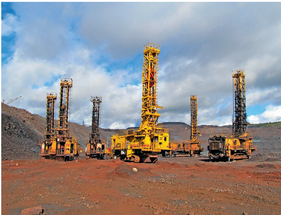
Буровые станки СБШ производства «Рудгормаш» в карьере Михайловского ГОКа
