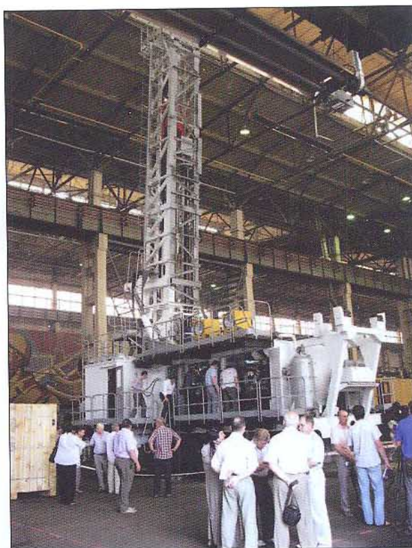
Модернизированная Рудгормашем в 2010-2011 гг. модель станка СБШ-250Д с дизельным приводом, который был поставлен на ООО «Хакасвзрыв-пром»; в настоящее время идет его доработка для серийного производства
