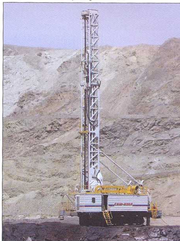
Модернизированный станок СБШ-270А, поставленный в 2008 г. на железорудный карьер Chador Malu (Иран)
