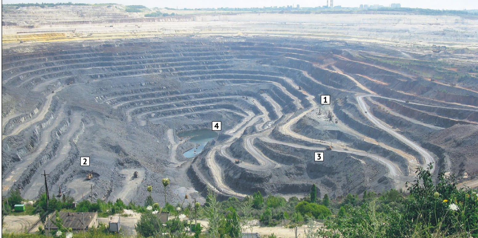
1. Наши СБШ-250. 2. Экскаваторы черпают горную массу, потом грузят её на транспорт. 3. БелАЗы вывозят руду из карьера. Кроме того, руду транспортируют ещё по железной дороге и конвейером. 4. Озеро
